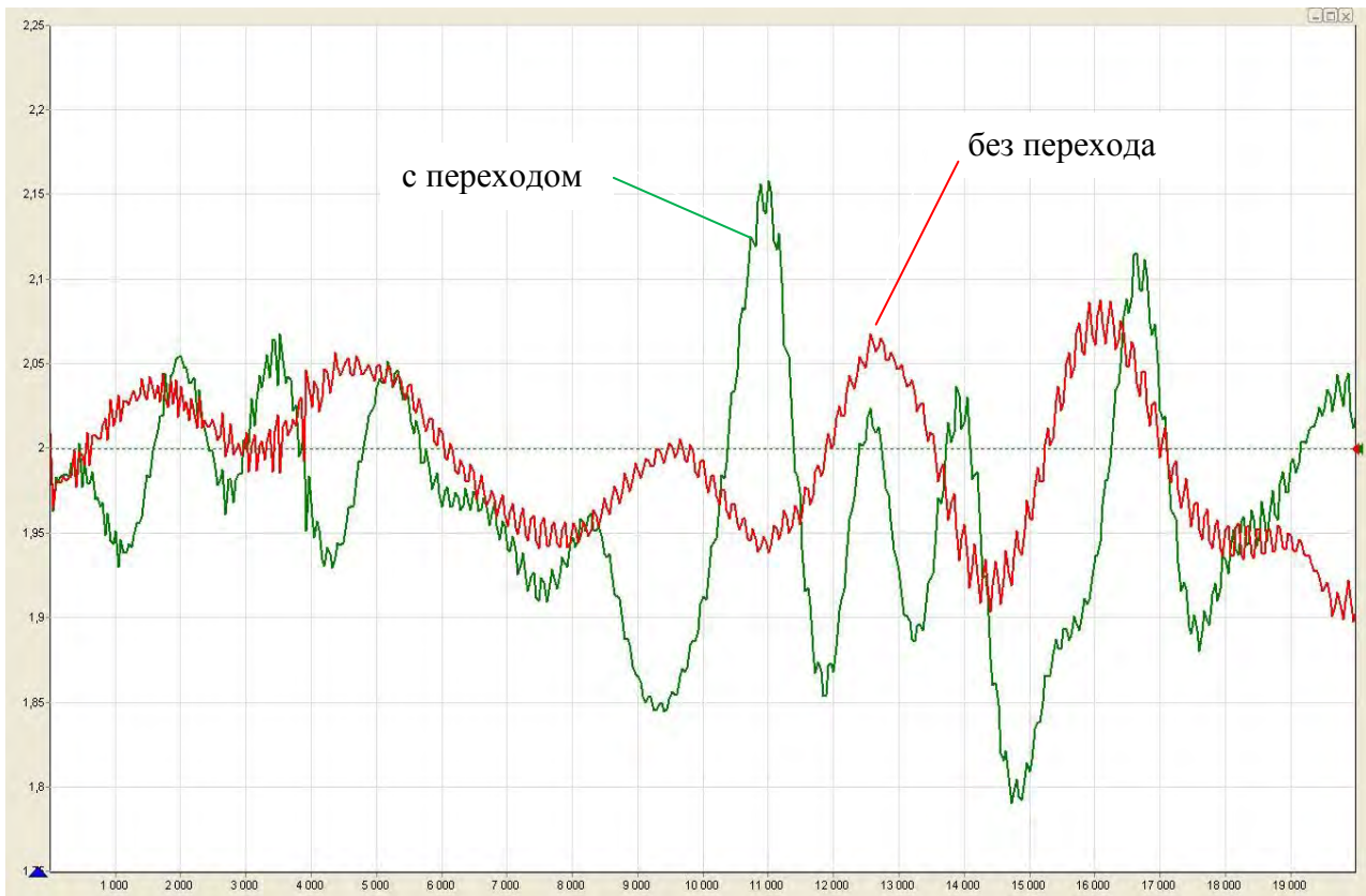
Рисунок 5.19 – Результаты измерений КСВН нагрузки (КСВН = 2,0)
