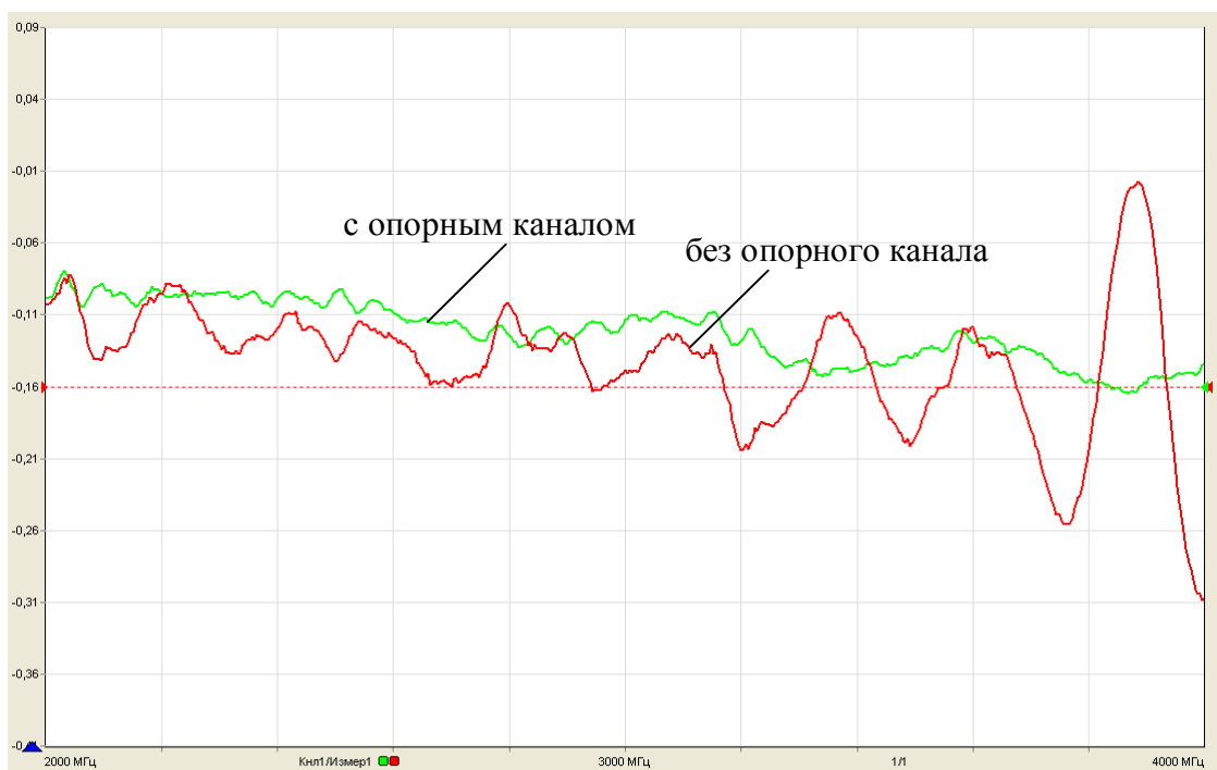
Рисунок 5.9 – Измерение модуля КП кабельной сборки
