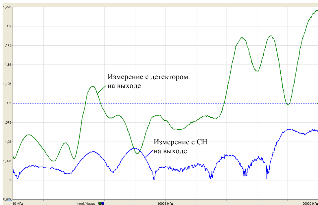
Рисунок 5.18 – Результаты измерений КСВН перехода
