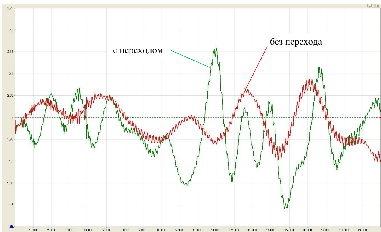
Рисунок 5.16 – Результаты измерений КСВН нагрузки (КСВН = 2,0)
