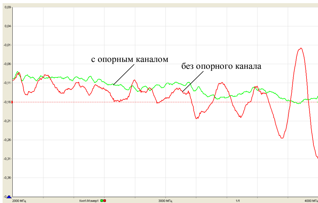
Рисунок 5.9 – Измерение модуля КП кабельной сборки
