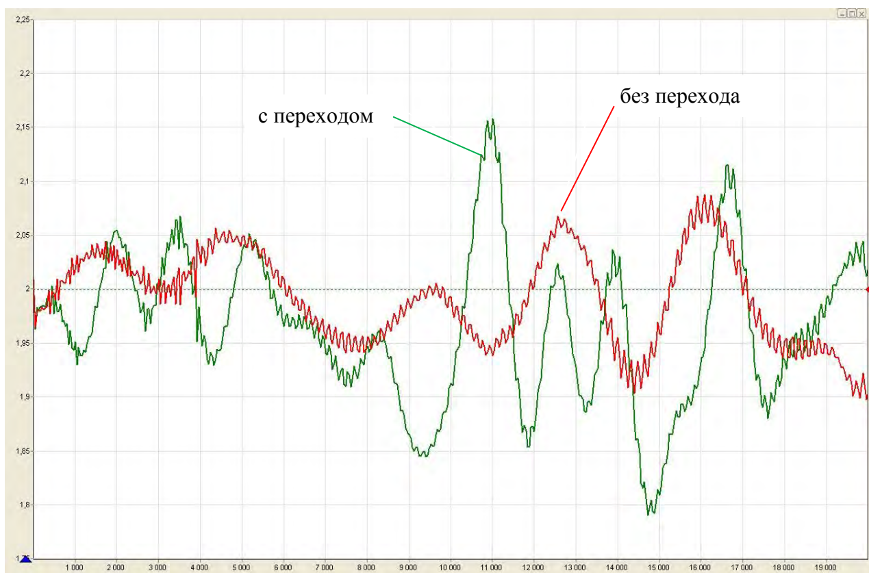
Рисунок 4.19 – Результаты измерений КСВН нагрузки (КСВН = 2,0)
