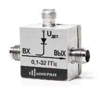
Главное отличие серии ДПМ от серии Д5 заключается в том, что детекторы ДПМ являются направленными, то есть часть мощности высокочастотного сигнала, проходящего от СВЧ-входа детектора к СВЧ-выходу, ответвляется из основного канала во вторичный, где происходит детектирование сигнала.
